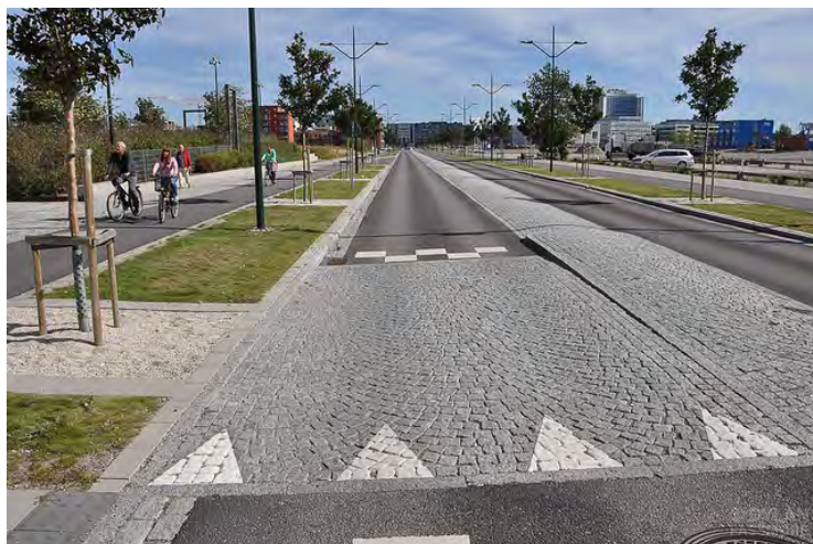
Photo 3 Exemple d'une intersection surélevée, Malmö, Suède
