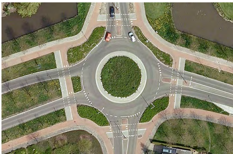
Photo 6 Exemple d'un giratoire avec piste cyclable sans priorité pour les usagers du vélo
