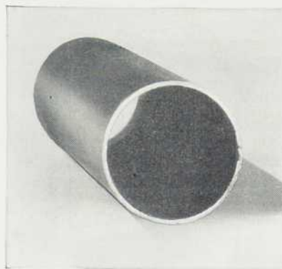
Coupe montrant le tuyau de cuivre en parfaite condition après 15 ans de service.
