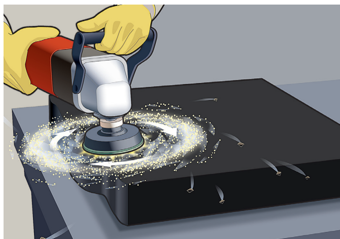
Figure 7 : Tourbillon de particules créé par des outils rotatifs à grande vitesse
