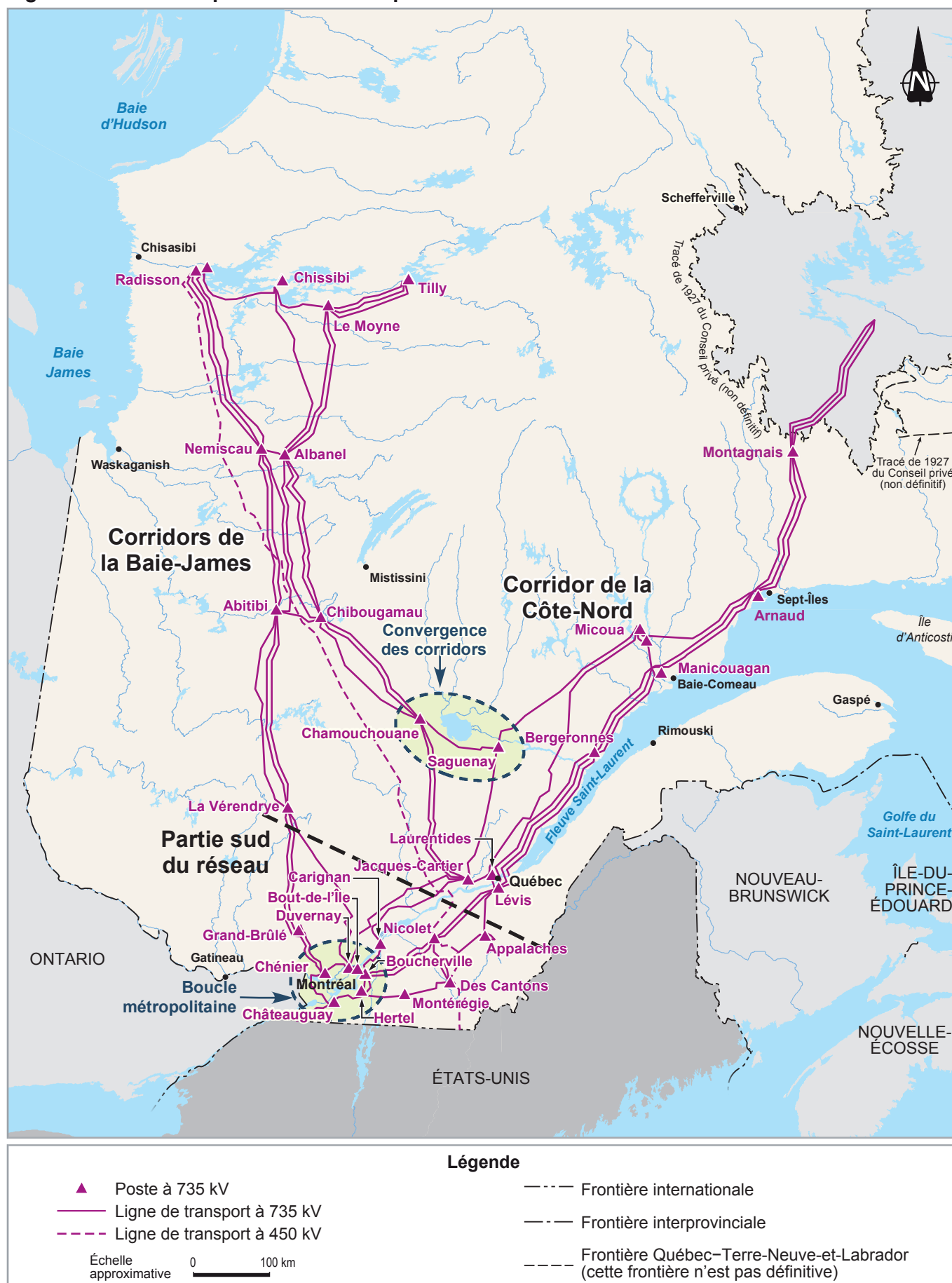
Figure 7 Le réseau québécois de transport à 735 kV
