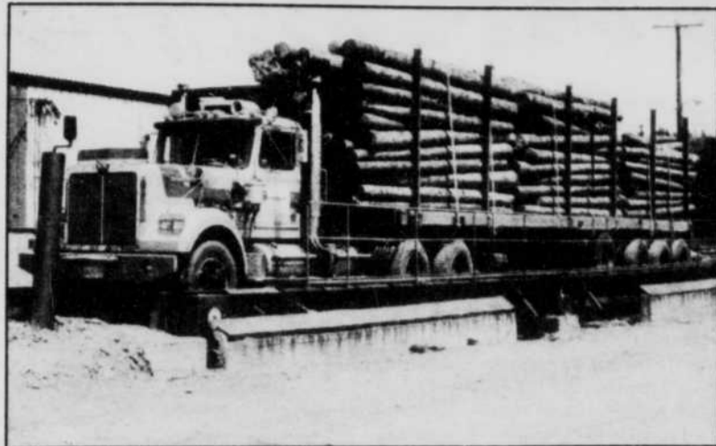
Les billes de bois font leur entrée à la scierie de Saint-Séverin et aussitôt, on détermine le poids qu'elles totalisent.
