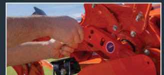
Angle de fanage facilement ajustable en fonction des conditions de travail
