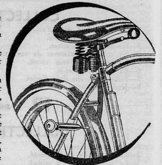
Partie de la fourche arrière montrant comment la "Serrure de Sécurité" est installée.
