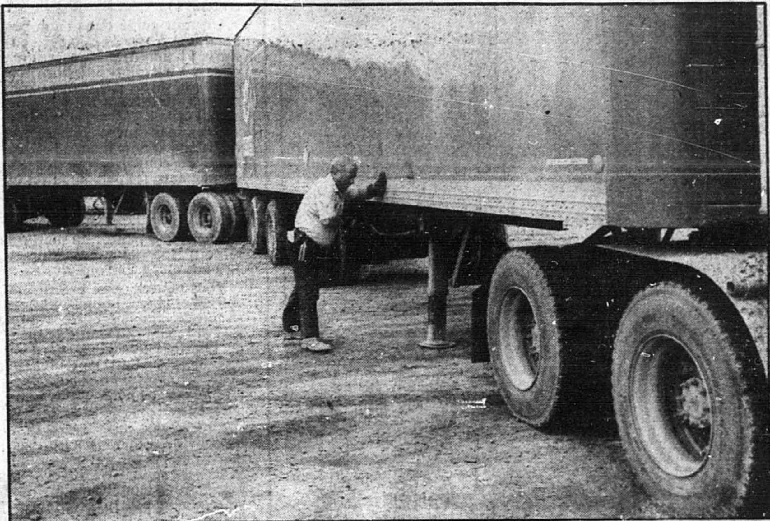
Les charges autorisées sur un essieu tandem, comme à l'arrière de cette remorque, sont plus élevées au Québec que dans le Vermont ou dans l'État de New York.
