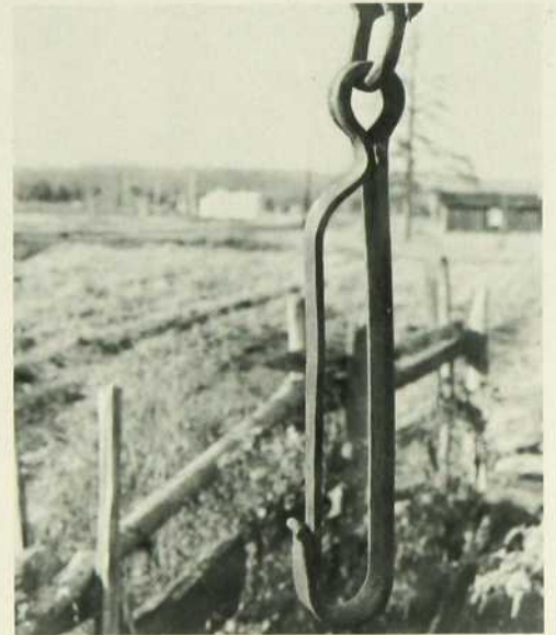
La "main" de la brimbale, d'une seule pièce en fer martelé, elle retient le seau accroché solidement à la perche.
