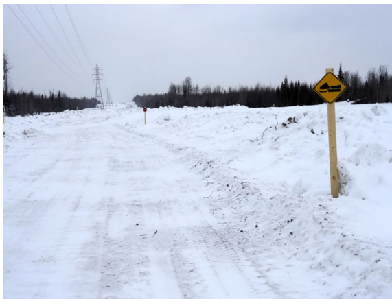
Photo H.3 : Signalisation à la traversée d'un sentier de motoneige
