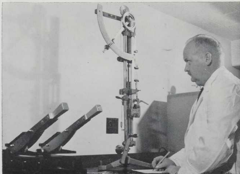
ON EMPLOIE DES COUPEUSES DE PRECISION POUR TAILLER DES ECHANTILLONS DE PELLICULE SOUDEE, APRES QUOI ON CALCULE LA RESISTANCE DU JOINT AU MOYEN D'UN TENSIONMETRE (A DROITE).
