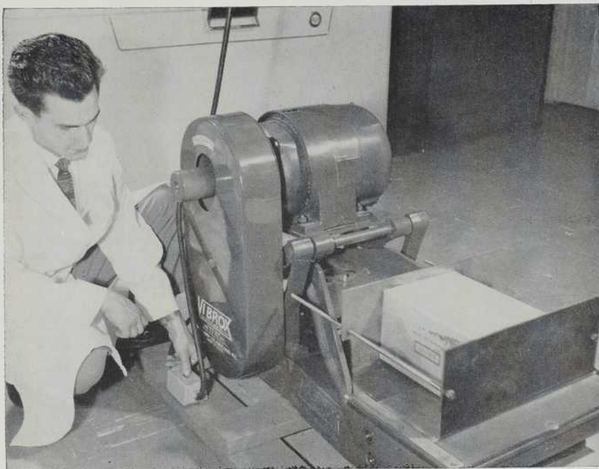
EN HAUT : ON EMPLOIE UN "VIBRATEUR" POUR IMITER LA VIBRATION QUE SUBISSENT LES CAISSES EN COURS DE TRANSPORT. EN BAS : LE MEME COLIS VIENT DE SUBIR UN ESSAI AU CHOC AU MOYEN DUQUEL ON ETUDIE LES EFFETS DES CAHOTS.
