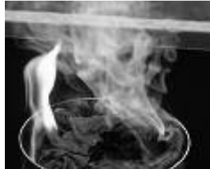
4) Le front du feu couvant atteint l'extérieur de la matière (ou le processus produit des cavités suffisamment grandes à l'intérieur de la matière) et des flammes prennent naissance. Il s'agit de l'inflammation.
