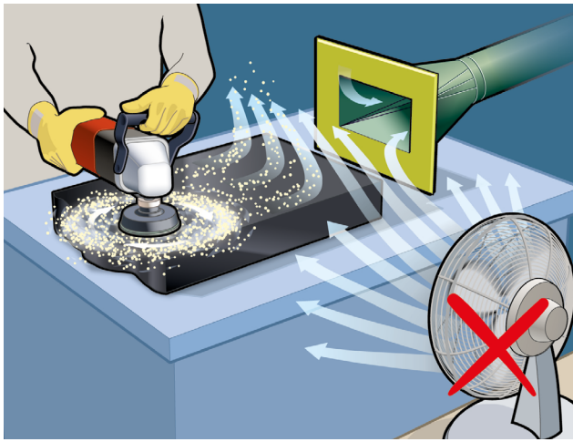
Figure 13 : Influence des courants d'air sur la captation des particules
