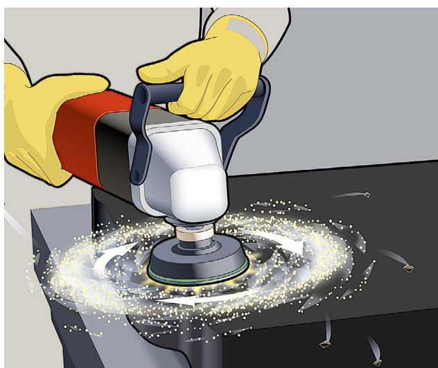
Figure 7 : Tourbillon de particules créé par des outils rotatifs à grande vitesse
