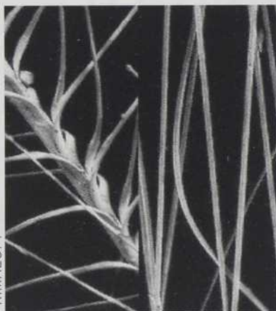
Le duvet naturel et un isolant synthétique grossis 200 fois.
