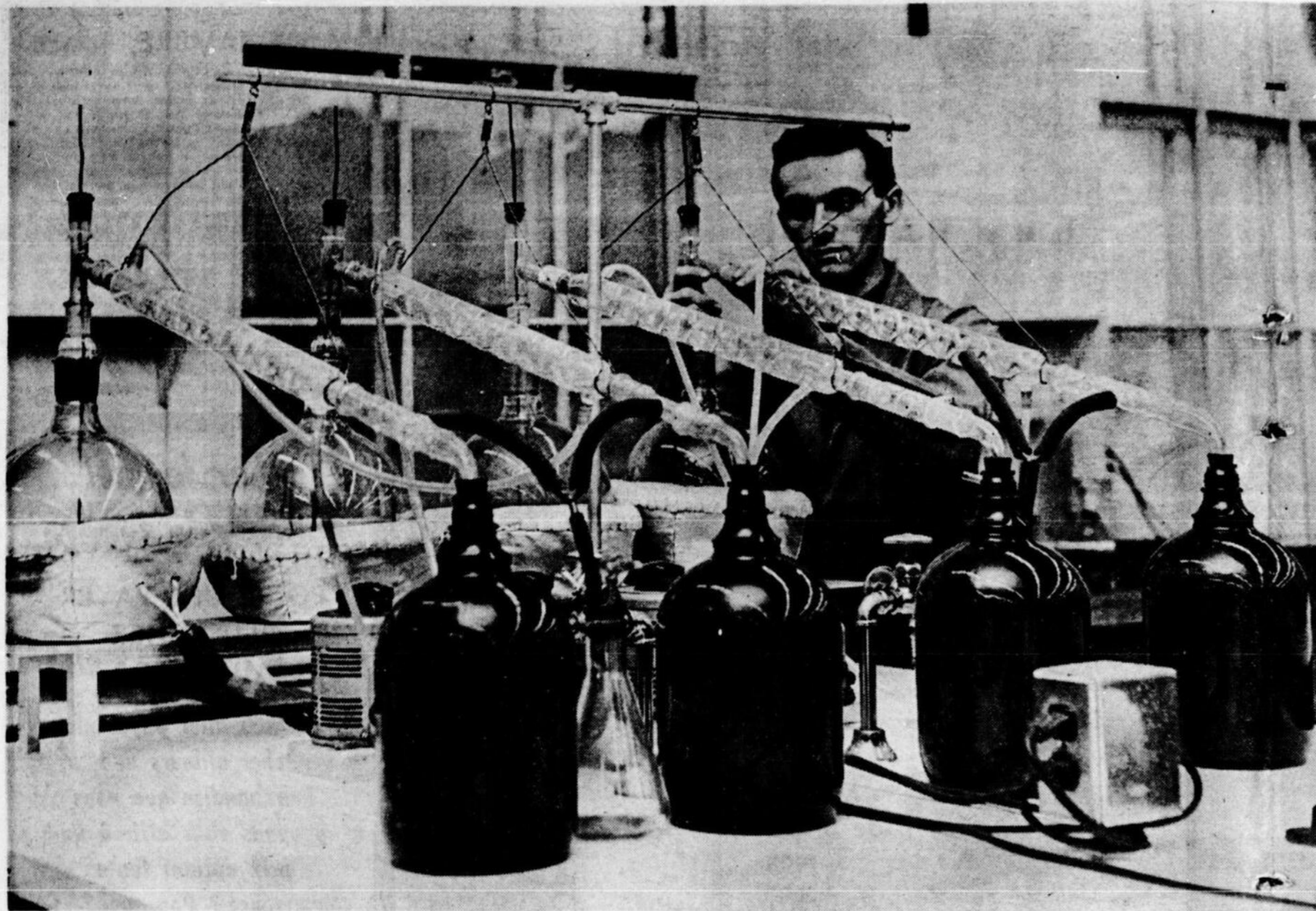
Cette installation, qui rappelle un alambic, ne sert pas à produire de l'alcool, mais à distiller de la peinture, pour analyse ultérieure.
