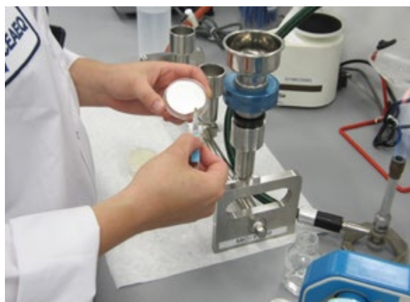
Analyse de coliformes totaux et de bactéries E. coli sur le milieu MI-agar. Photo : Étienne Walker-Lamontagne, CEAÉQ
