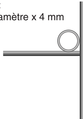
Figure 6 - Sections minimales pour les lisses de garde-corps appuyées sur des montants distancés de 3 mètres
