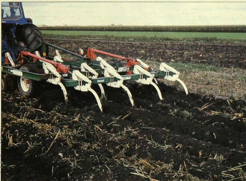
Le chisel mélange superficiellement les débris végétaux et favorise leur décomposition.
