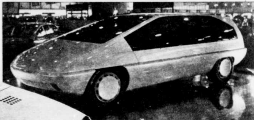
Une étude de carrosserie aérodynamique réalisée par les stylistes de Citroën. C'est la Xenia qui se caractérise par son avant bas et plongeant et un arrière tronqué.
