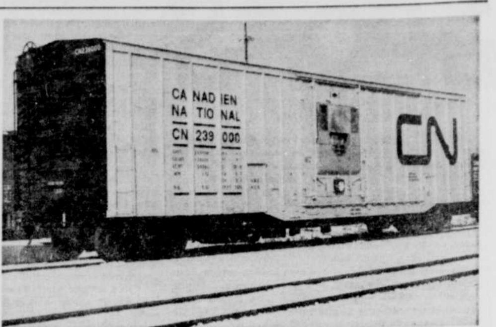
(Photo Canadian National) CE WAGON CONCU PAR le Canadian National est une importante réussite de la technique moderne. Il est réfrigéré ou chauffé, selon les denrées qu'il transporte. La température y est maintenue à un
