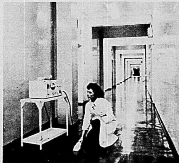
Même les couloirs d'une usine atomique sont soigneusement examinés, selon une cédule minutieusement suivie, pour déceler toutes traces de radioactivité.
