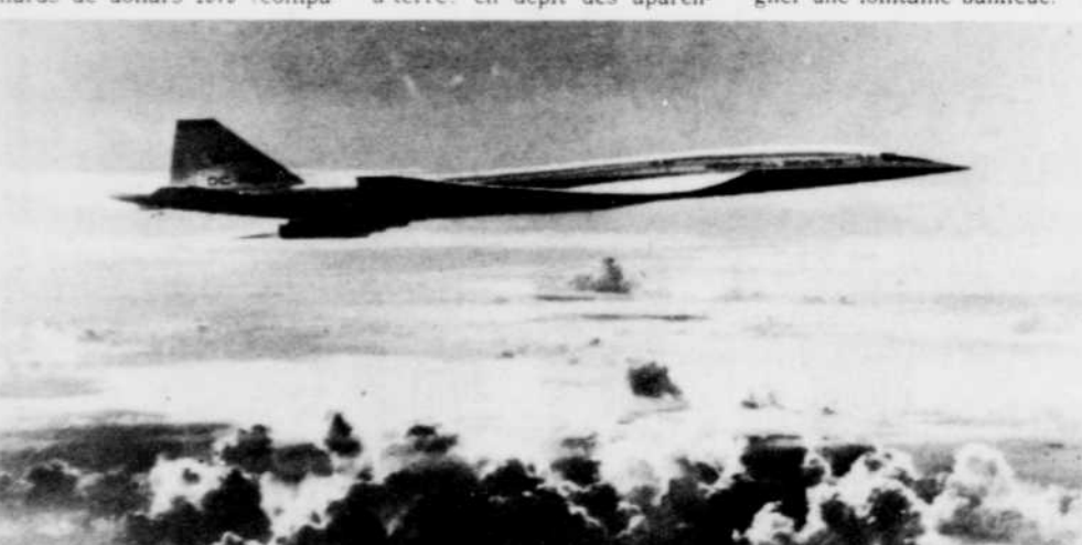
Maquette d'un transport supersonique avancé (Advanced Supersonic Transport) qui sera capable de transporter 300 passagers à 2,4 fois la vitesse du son.
