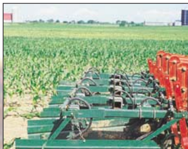
Les unités de travail des sarcleurs mi-lourds sont plus longues que celles des sarcleurs légers afin de permettre une meilleure circulation des résidus. Les tôles de protection de la culture mesurent 12 x 48 po. et leur hauteur s'ajuste par des chaînes. (Photo : Club de fertilisation de Beauce).
