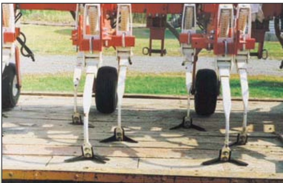
Disposition des 3 dents en C. Le soc arrière a 10 po. de largeur. Les socs avant peuvent être tronqués (largeur de 6 po.). La largeur totale travaillée par les trois socs est d'environ 18 po.
