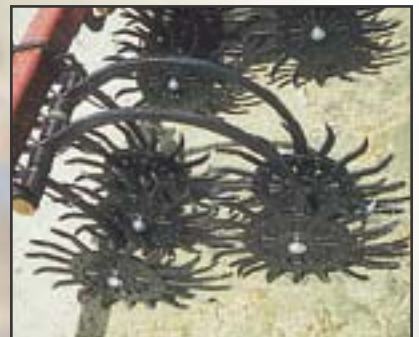
Passage à 1-2 feuilles du maïs. Une houe rotative “minimum-till” s’emploie aux mêmes stades de mauvaises herbes et de culture qu’une houe rotative conventionnelle.
