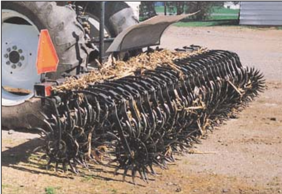
Large essieu évitant le bourrage par des résidus.
