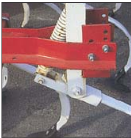
La tension de la dent arrière est ajustable en déplaçant des boulons.
