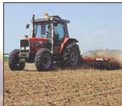
Passage à 1-2 feuilles du maïs. Une houe rotative “minimum-till” s’emploie aux mêmes stades de mauvaises herbes et de culture qu’une houe rotative conventionnelle.
