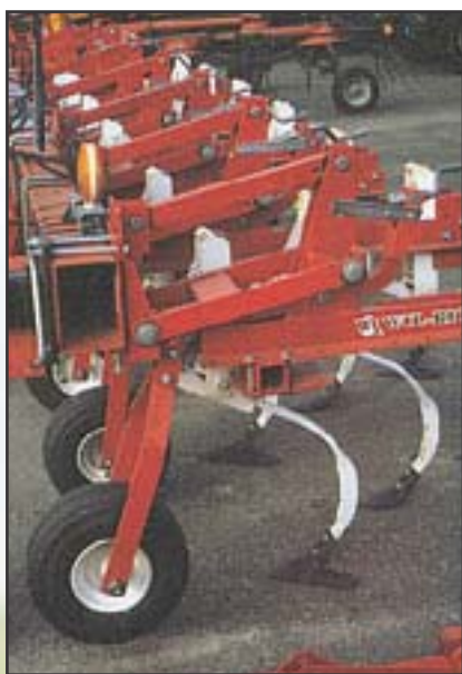
Sarcleur mi-lourd Wil-Rich. Trois dents en C par unité de travail (2 dents pour les extrémités). Cadre rigide de 5 x 7 po. Roues de profondeur pneumatiques. Dégagement vertical de 24 po.
