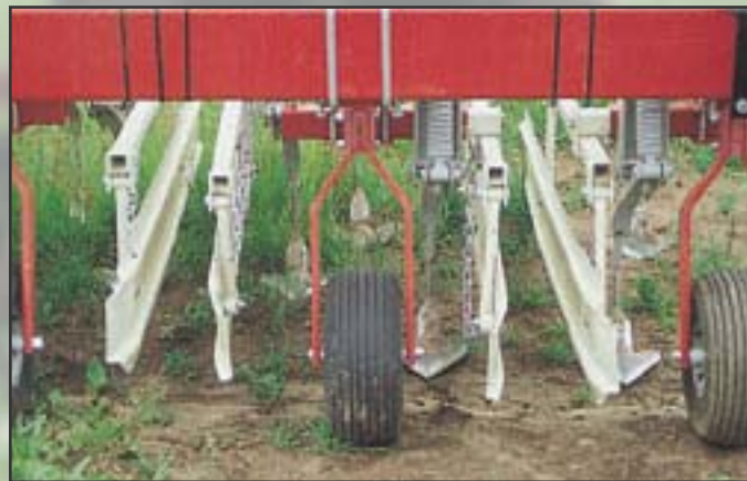
Les tunnels de protection, espacés de 7 à 8 po. sur le rang, protègent la culture d'une trop grande projection de sol. Surtout employés lorsque la culture est petite (maïs avec 4 à 6 feuilles). Certains agriculteurs n'en utilisent pas, préférant réduire la vitesse de passage afin de projeter moins de sol.
