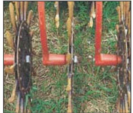
Large essieu évitant le bourrage par des résidus.
