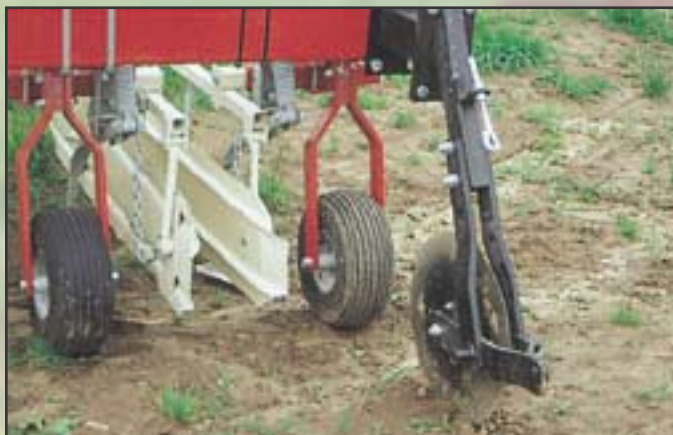
Le contre-guide et les roues pneumatiques procurent de la stabilité verticale et latérale au sarcleur. Notez les tunnels de protection.
