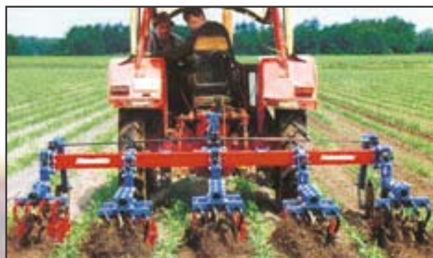
SarclEUR rotatif Hatzenbichler à 4 rangs dans du maïs au stade 5-6 feuilles. Deux groupes de 4 roues-araignées par unité de travail (1 groupe pour les extrémités). Les groupes portés sur des tubes métalliques sont entraînés par l'avancement du tracteur. Cadre de 4 x 5 po. environ. (Photo : Hatzenbichler).
