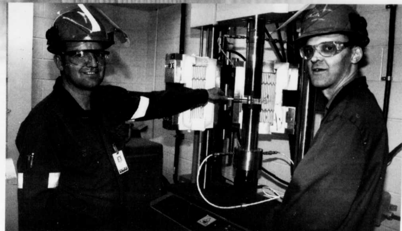
Clément Boudreau, technicien en métallurgie, et Martin Fortier, chargé de projet pour les billettes de forgeage, posent devant un simulateur de forgeage d'une capacité de 250 kilo-Newton (kN) et d'une vitesse maximale de 7 mètres/seconde, un équipement de pointe unique au Canada.
