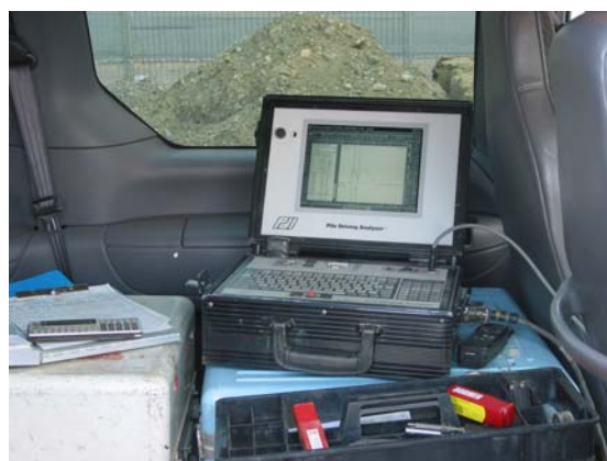
18. Essai dynamique : analyseur de battage
