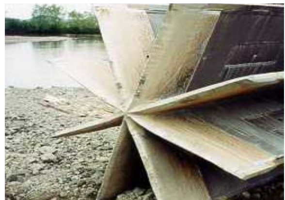
10. Trépan pour la réalisation de l'emboîture
