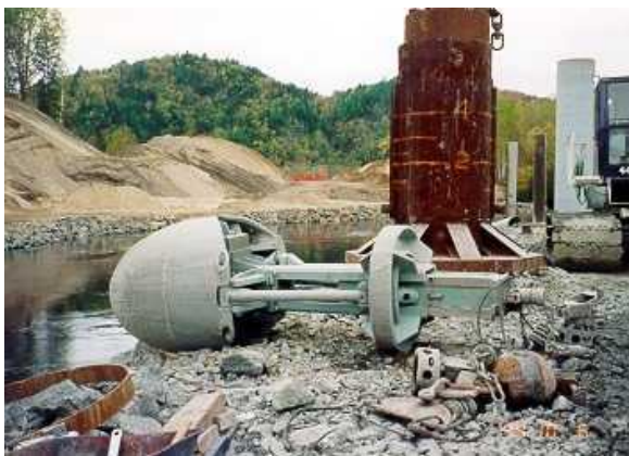
9. Clapet pour excaver l'intérieur d'un pieu caisson
