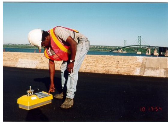
10. Mesure de la compacité au nucléodensimètre
