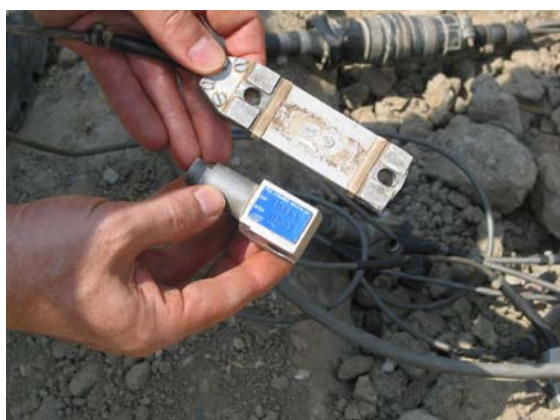
17. Essai dynamique : jauge de déformation et accéléromètre
