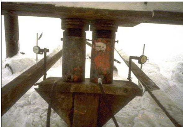
21. Essai de chargement : manomètres, vérins et extensomètres
