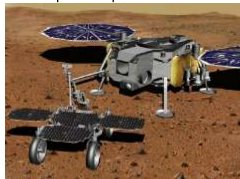
Un véhicule navette (à gauche) récupère les échantillons de Perseverance et les rapporte au Lander .
