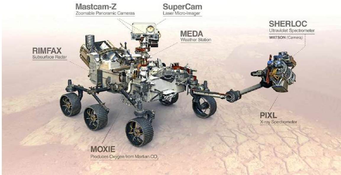
Anatomie du véhicule Perseverance , porteur d'un bras instrumenté de 2,1 mètres de long.
