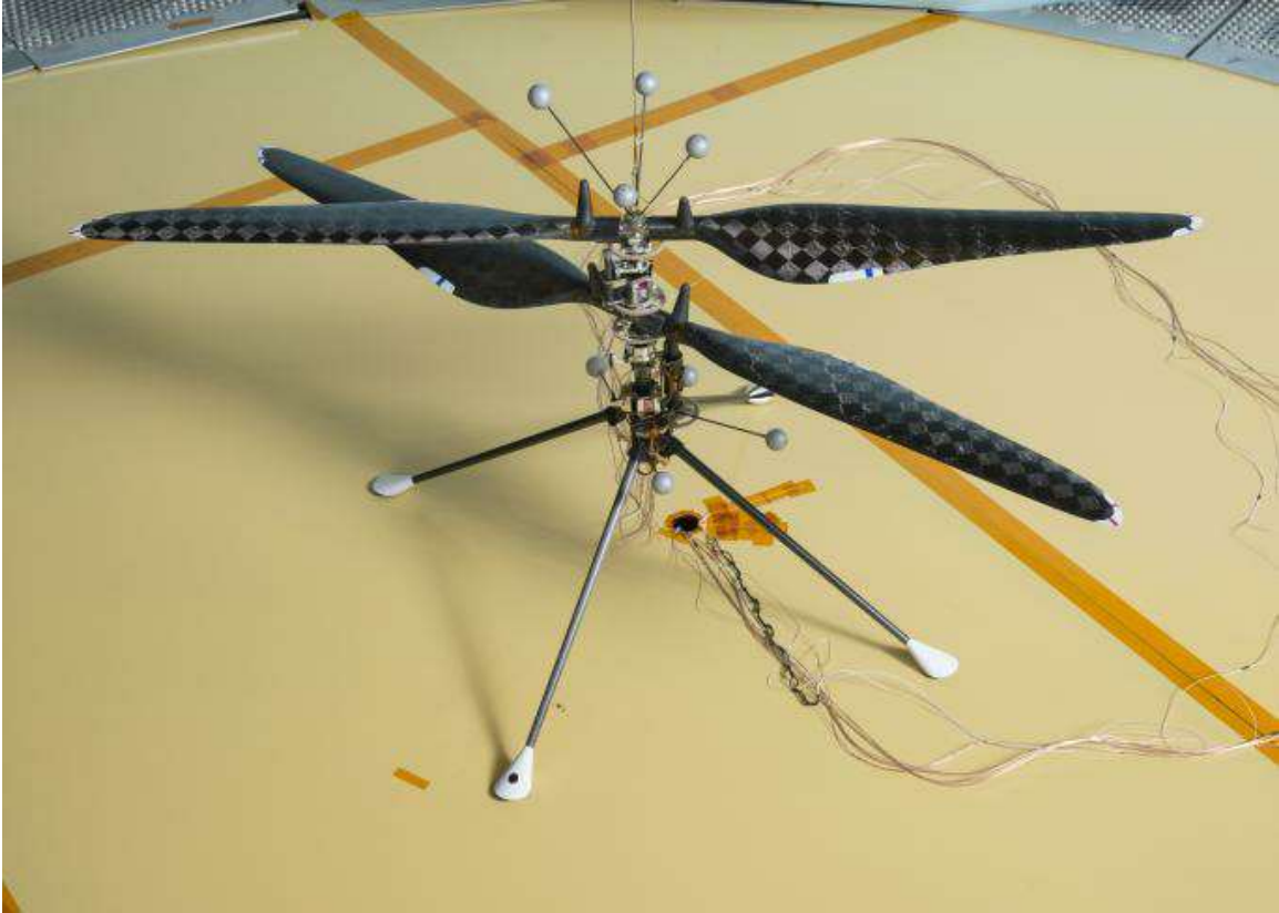
L'ingénieux micro-hélicoptère conçu par la NASA: 49 cm de haut et ne pesant que 1,8 kg.
