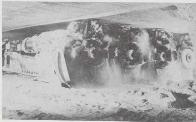
▲ UNE «TAUPE AUX DENTS DE FER» — De grandes foreuses, mues à l'électricité, servent à extirper le minéral, à teneur de potasse, du sous-sol des Prairies. A chaque minute, elles progressent d'environ 3 mètres, creusant des tunnels de 2,5 mètres de diamètre, en rejetant leurs «bouchées» dans de petits convoyeurs.
