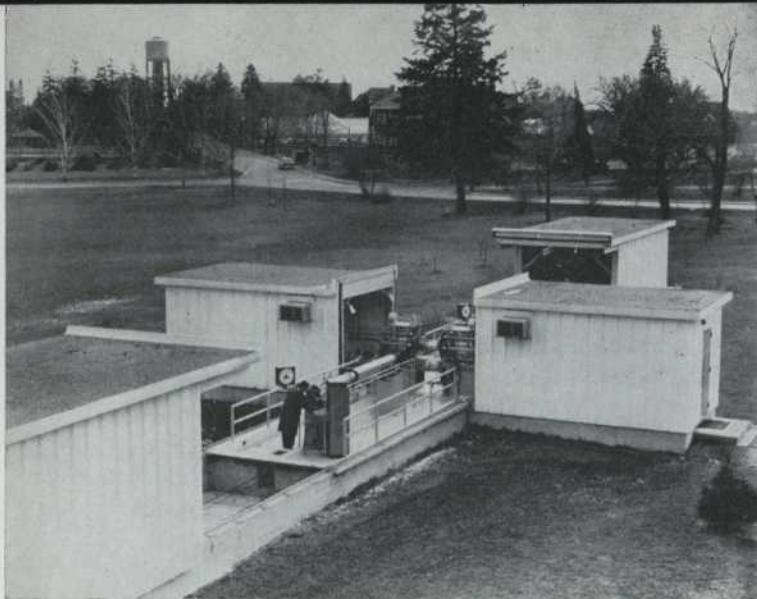
Un abri amovible protège la lunette de passages à réflexion conçue et réalisée par les astronomes de l'Observatoire fédéral d'Ottawa.
