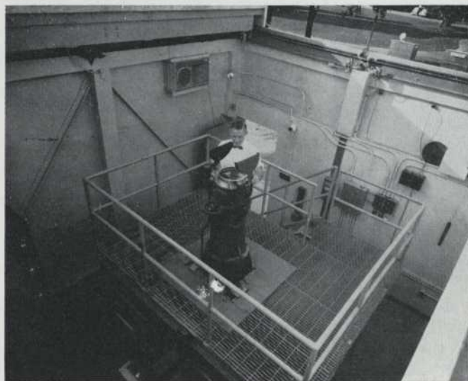
Logée dans un abri à toit amovible, en face de l'Observatoire fédéral d'Ottawa, la lunette zénithale à chambre noire est protégée à la fois contre l'éclat du soleil et les intempéries.
