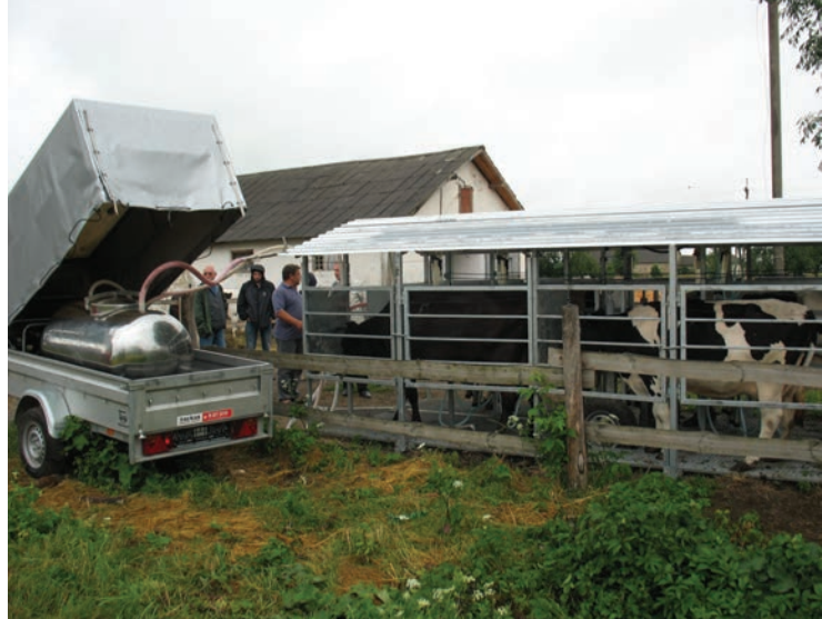
Cet équipement portatif comprend une plateforme pouvant traire 4 vaches à la fois, une génératrice et un réservoir. Reste à installer un corral pour y amener les animaux.
