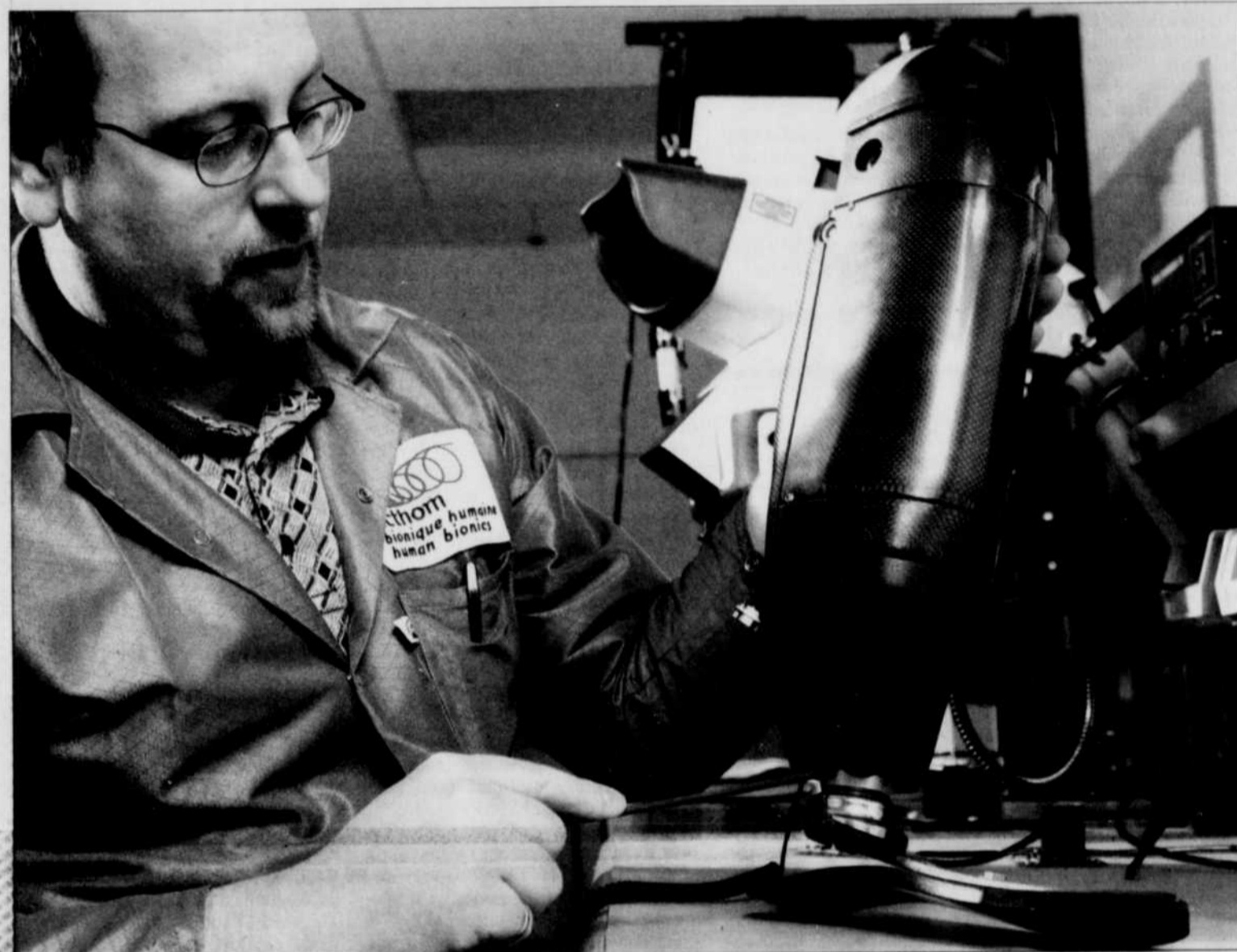
La jambe est munie de capteurs et anticipe les mouvements de celui qui la porte.
