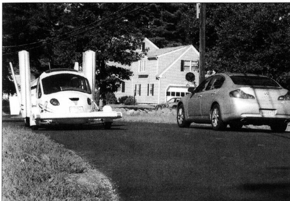
Une fois les ailes repliées, le Transition occupe une hauteur de 2,06 mètres par une largeur de 2,01 mètres.
