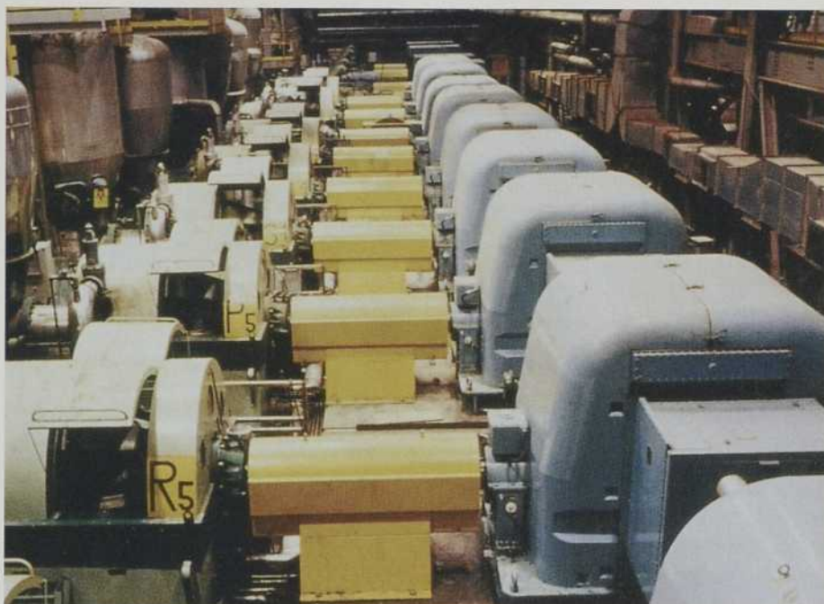
Une série de raffineurs. C'est ici que commence la fabrication de la pâte à papier.
