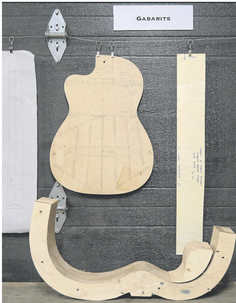
Différents gabarits permettent la fabrication de ses œuvres.
