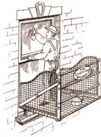
Une des trouvaillles de Guyon, un balcon ajustable pour le lavage des châssis.
