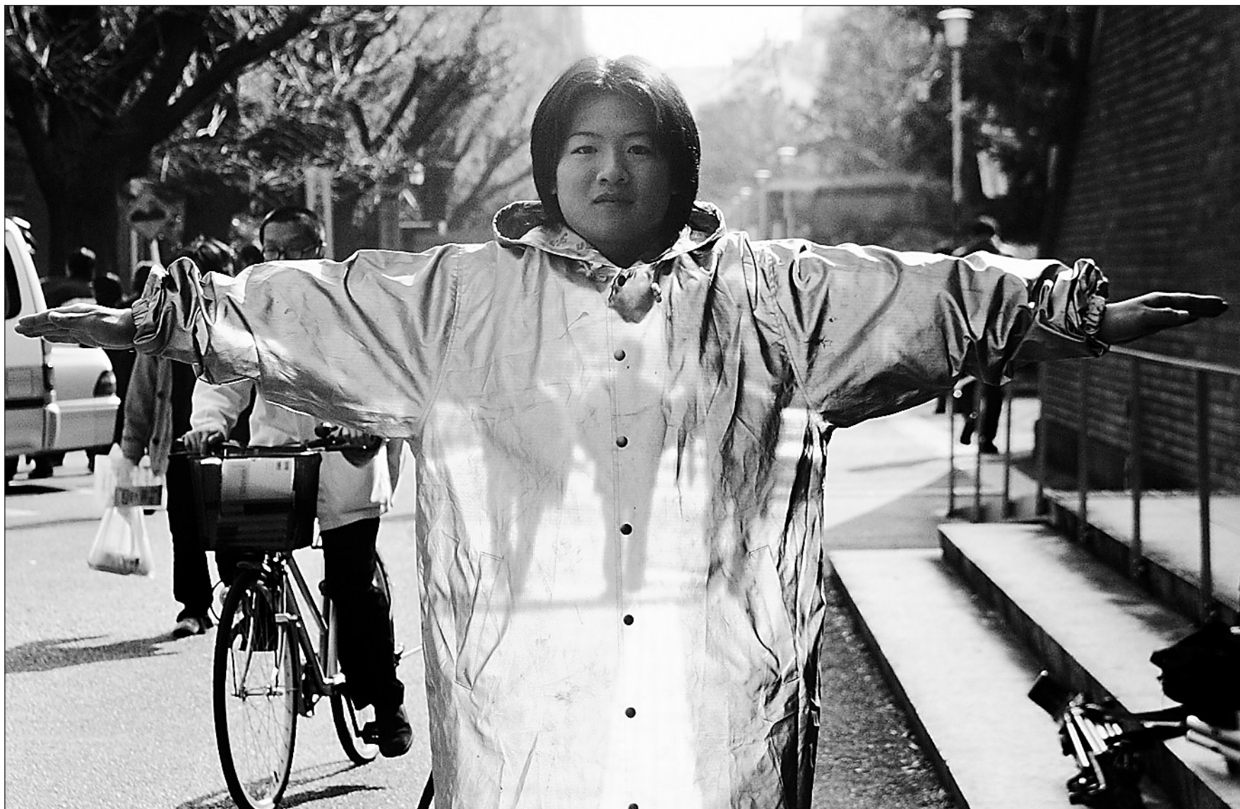
Une image qui a fait le tour de la planète, en février dernier : Kazutoshi Obana, un étudiant de deuxième cycle à l'Université de Tokyo, n'est pas transparent pour vrai. Son « imperméable » capte les images derrière lui et les projette sur le devant.
