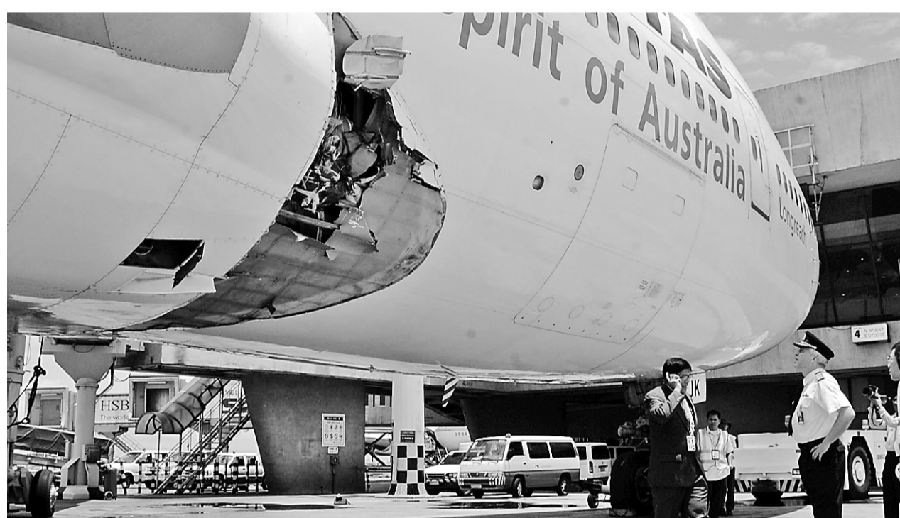
L'explosion a ouvert un trou de 2,5 à 3 m de diamètre sur le côté droit du Boeing.
