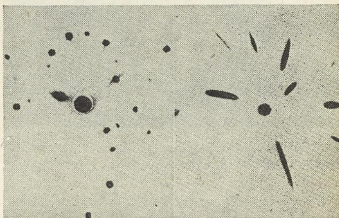
FIG. 18. Spectre de diffraction d'un cristal d'aluminium, avant (gauche) et après (droite) déformation de 9%. (Czochralski).
