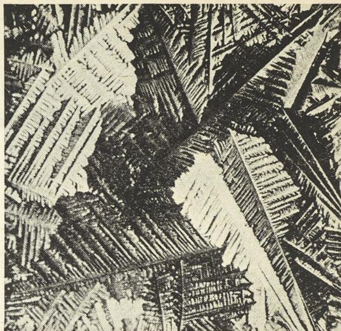
FIG. 2. Surfaces de cristaux d'antimoine (Desch).
