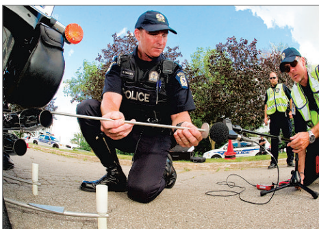
Les policiers s'affairent à installer le sonomètre avant d'effectuer un test pour calculer les décibels d'un silencieux.
