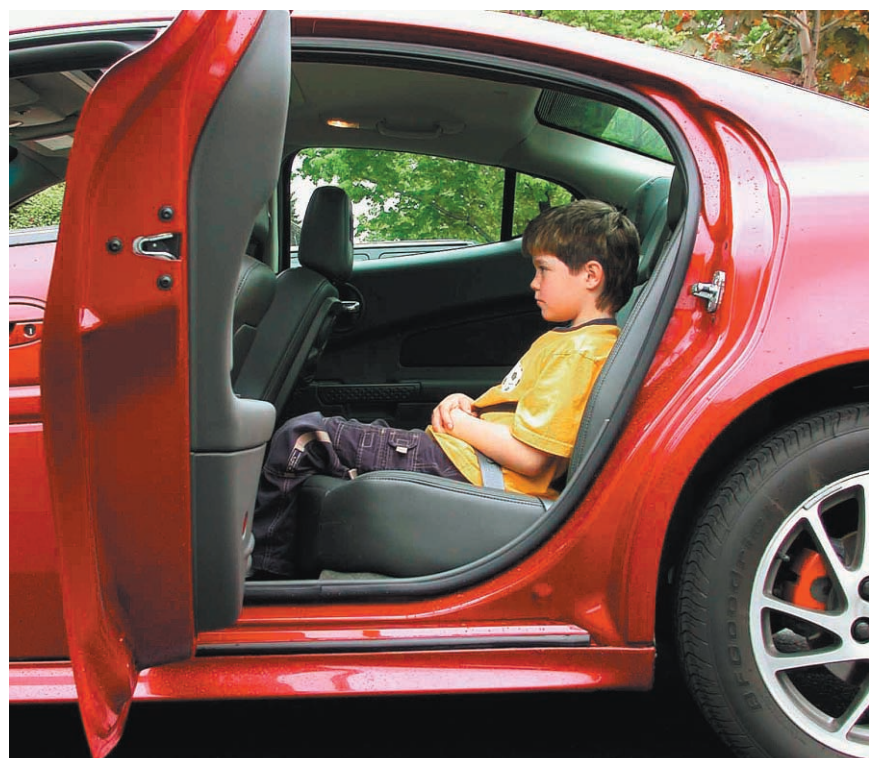
En raison de la ligne tombante du toit, le coussin de la banquette arrière a été ancré beaucoup trop bas. À noter : l'angle d'ouverture des portières. Impressionnant !
