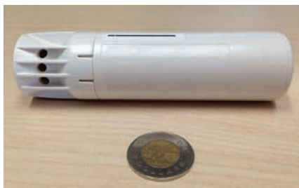
Exemple d'un dispositif de bolus ruminal que l'animal avale et qui enregistre l'ensemble des données de pH.
