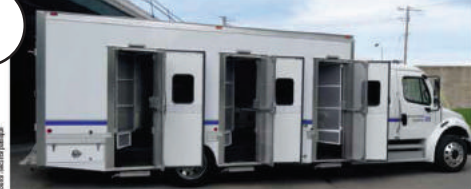
► Le véhicule est fait de compartiments de différentes tailles, séparés les uns des autres par des parois.
