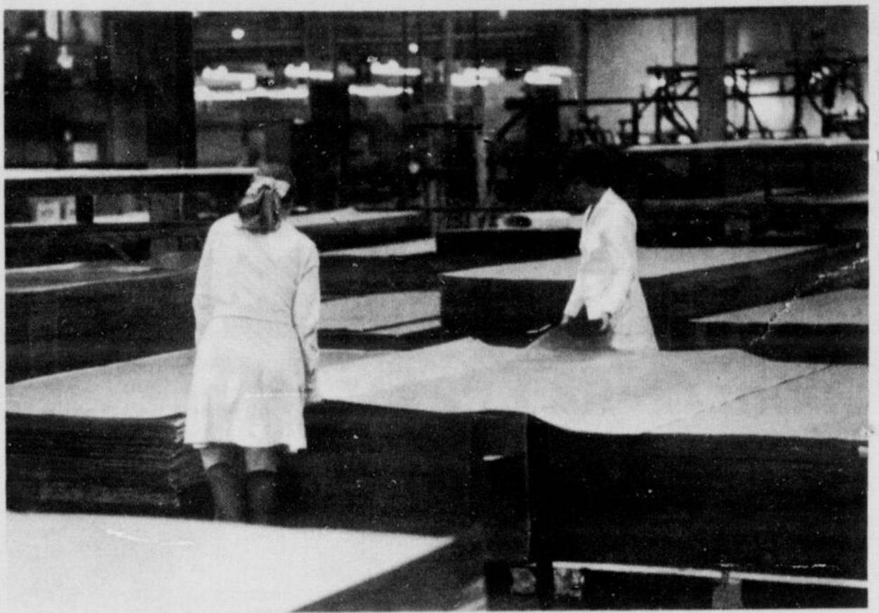
Selon les spécifications de la commande, des ouvrières assemblent le nombre requis de feuilles séchées qui déterminent l'épaisseur ultime du panneau de "Formica" à la fin de la chaîne de production.
