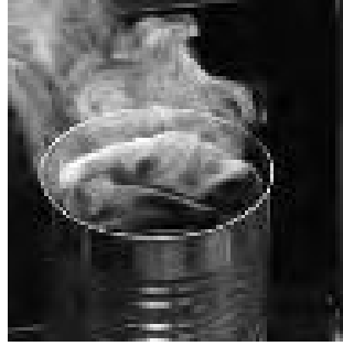
L'auto-échauffement est assez important pour mener à l'emballement thermique.
