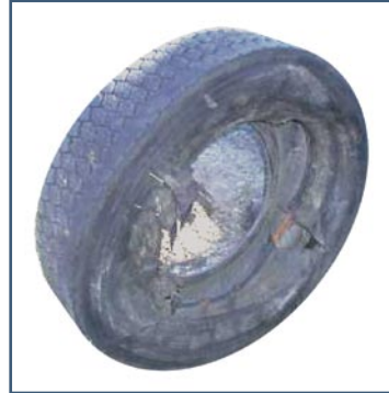
Photo n° 2 : Pneu ayant éclaté alors qu'un fardier était frappé par un arc électrique à proximité d'une ligne à haute tension.
