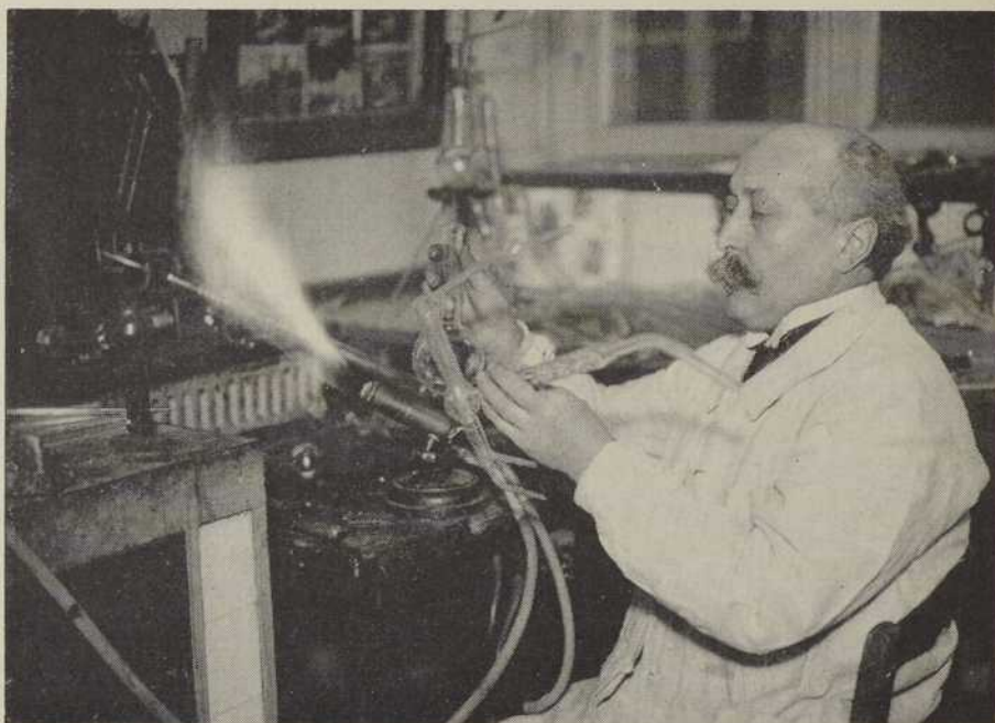
Fabrication, au chalumeau à gaz d'éclairage, d'un appareil de dosage de produits ammoniacaux.
