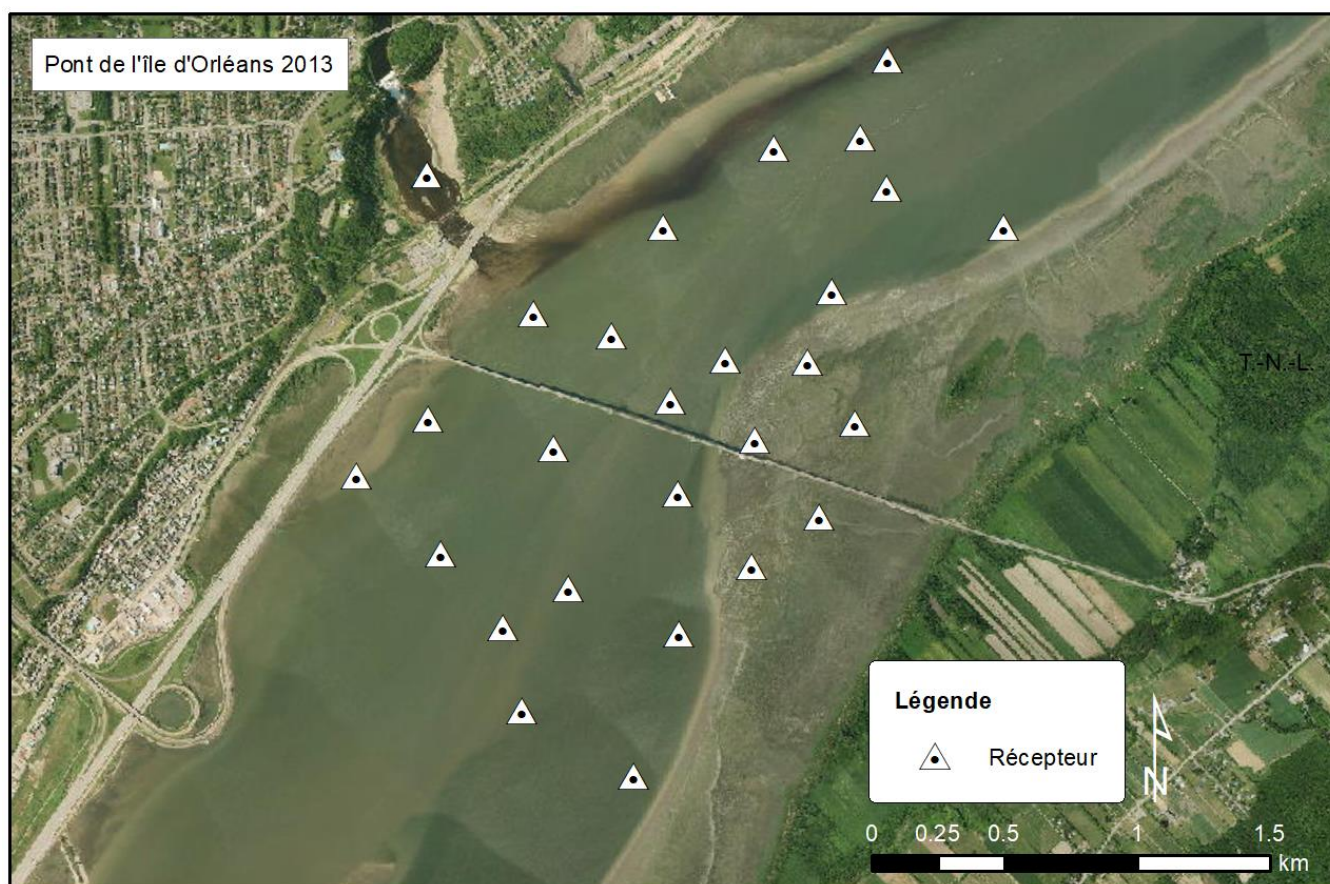
Figure 6 : Position des récepteurs acoustiques dans la grille de positionnement déployée par le MFFP dans le secteur du pont de l'île d'Orléans en 2013.
