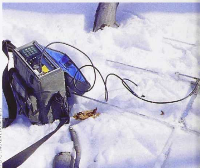
Récepteur et antenne de radiotéléométrie qui servent à mesurer la température corporelle des tamias en hibernation.
