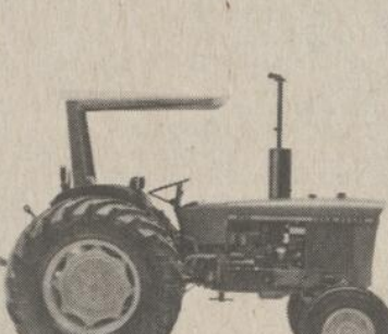
Le 2130 de 66 chevaux est équipé d'un moteur diesel à 4 cylindres
