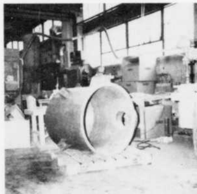
Réservoir Anti-Corrosion, 4'-0" x 6'-0", totalement fabriqué en fibre de verre.
