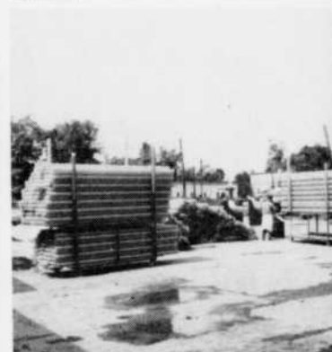
Conduits CGE 6000, en plastique renforcé pour installations souterraines. Diamètre 3 1/2" — Longueurs : 10' et 20'.
