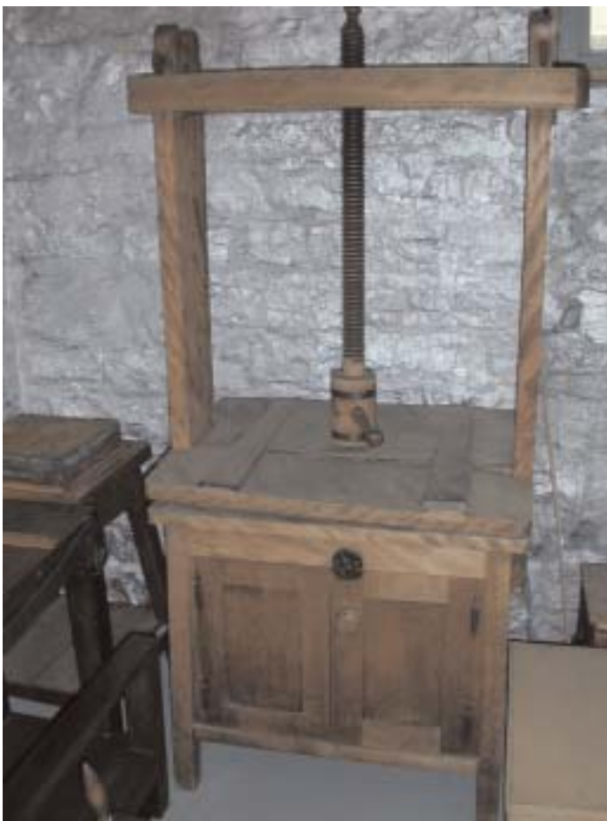
Figure 156 : Presse manuelle pour la reliure. (2002-2662)
