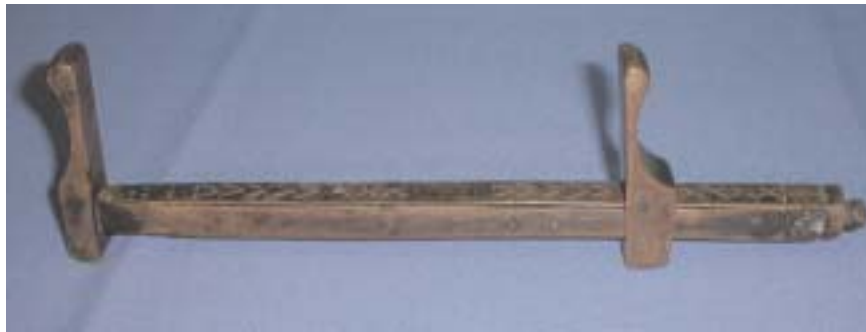
Figure 98 : Compas à pied. Cet objet qui sert à mesurer la pointure des pieds a été utilisé par les sœurs cordonnières jusqu'en 1945. (2002-871)
